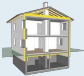
Die Außenwand des Bestandshauses besteht aus einem Hochlochziegelmauerwerk mit 4 cm Dämmputz an der Außenseite. Die Decke gegen den Dachraum ist als Betondecke mit 4 cm Dämmung und Estrich an der Oberseite ausgeführt. Die Decke zum Keller ist ebenfalls eine Betondecke mit einer 3 cm dicken Dämmplatte im Fußbodenaufbau. Als Fenster wurden Holzfenster mit einer Zweischeiben-Isolierverglasung eingebaut.
